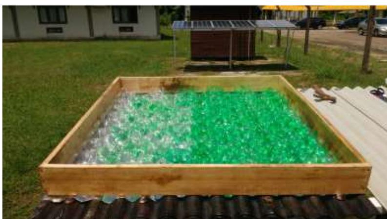
Figura 9: Camada de drenagem elaborada com PET.
