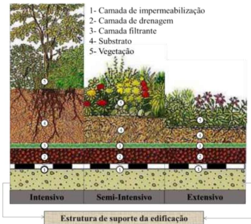
Figura 1: Tipos de aspectos construtivos para telhados verdes.
