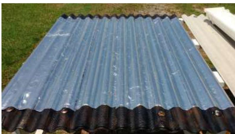
Figura 8: Manta impermeabilizante asfáltica.
